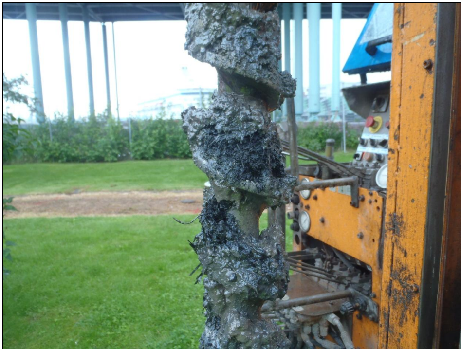
Bild 4 Synlig oljefilm på materialet vid provpunkt 18
